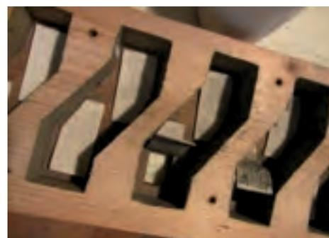
Photo 3 : Boîte à soupapes avant réfection
